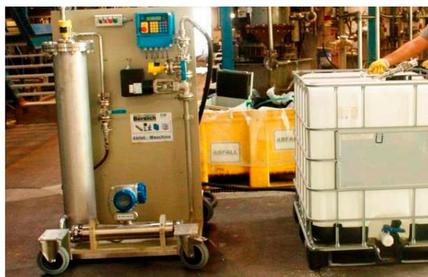
Мобильная измерительная система с использованием OPTIMASS 7300 C
