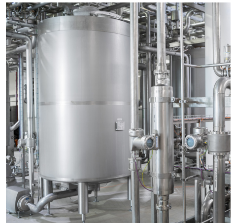
Milchstandardisierung mit dem OPTIMASS 2300 C
