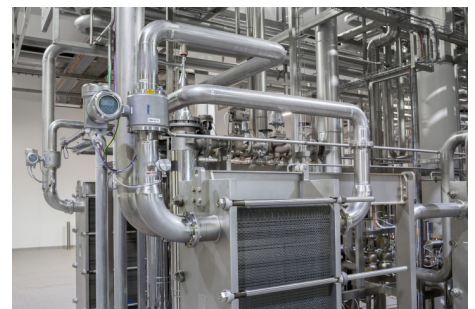
Milchpasteurisierung mit dem OPTIFLUX 6300 C
