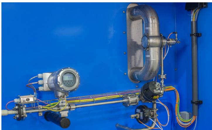
Контрольно-измерительное оборудование для системы очистки CIP (безразборная промывка): Управление запасами с помощью уровнемера OPTIFLEX 2200 (вверху и по центру слева). Дозирование чистящих средств для CIP-процессов (внизу) и измерение расхода линий системы CIP (вверху / по центру справа).
