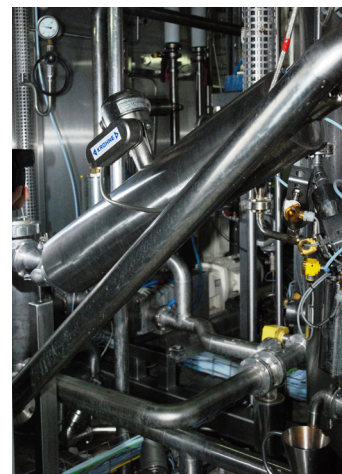
Medida de caudal de preparados de fruta con el OPTIMASS 7300 W
