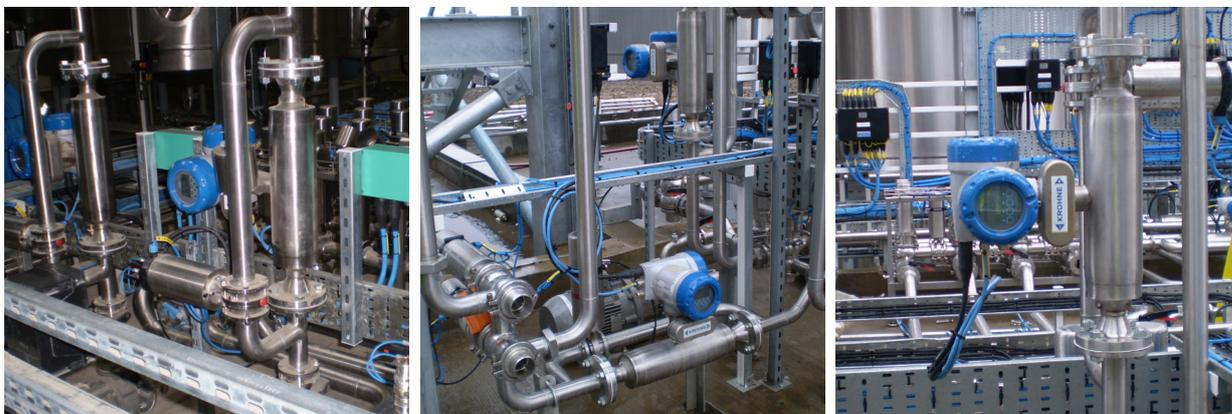
Durchflussmessung von Single Malt Whisky mit dem OPTIMASS 1300 C
