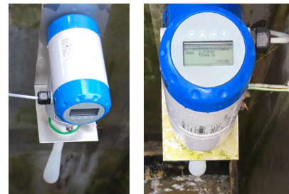
Schnelle Umrüstung des Messumformers durch Schnellkupplungssystem
