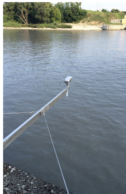
OPTIWAVE 5200, измеряющий уровень воды
