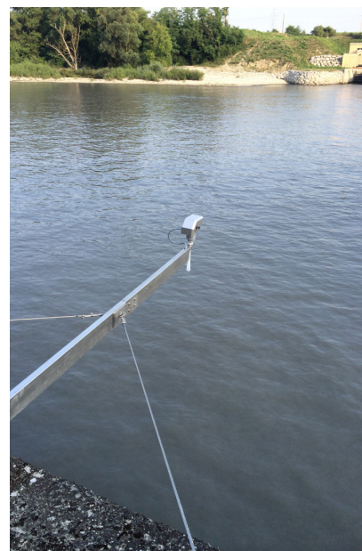
OPTIWAVE 5200 mesurant les niveaux d'eau
