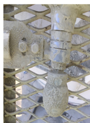
Прежнее радарное устройство OPTIWAVE 6300 с каплевидной антенной
