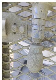
Ancien radar OPTIWAVE 6300 avec antenne Drop
