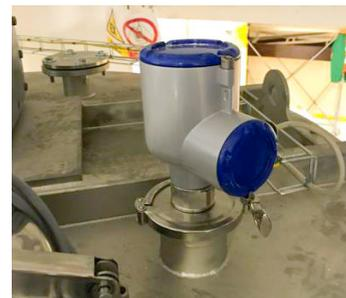
OPTIWAVE 7500 mit Tri-Clamp-Anschluss
