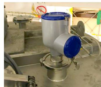
OPTIWAVE 7500 avec raccordement Tri-Clamp
