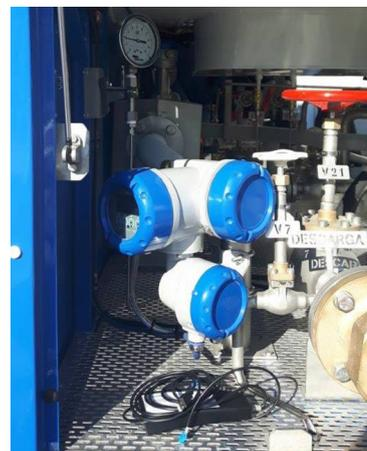
Преобразователь сигналов кориолисового массового расходомера OPTIMASS 6400, монтируемый с топливораздаточной системой для СПГ
