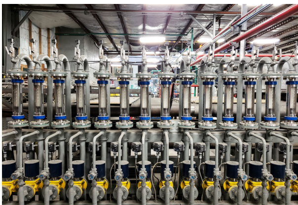
Измерение расхода водорода с помощью ротаметра VA 40
