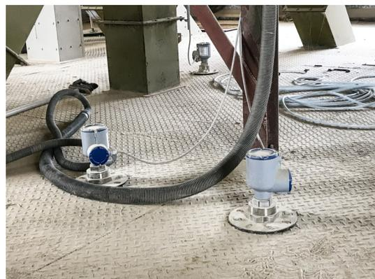
Mesure de niveau dans des silos d'alimentation animale et de grain bruts
