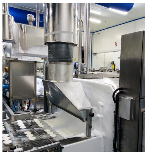
Schockgefrosteter Ziegenkäse aus Gefriertunnel; oben: OPTIMASS 6400 F
