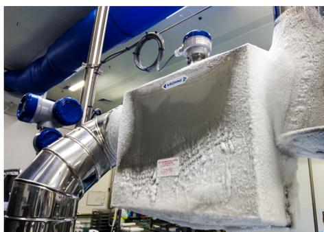
Mesure du débit massique d'azote liquide pour tunnels de surgélation avec l'OPTIMASS 6400 F
