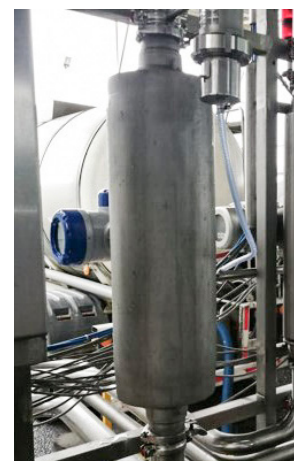
Medida de caudal en la recepción de leche cruda con el OPTIMASS 1400
