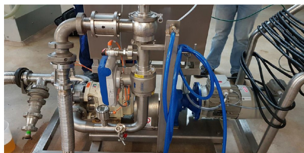
Mobilní měřicí a řídicí jednotka obsahující OPTISYS TSS 3050 a OPTIFLUX 6100
