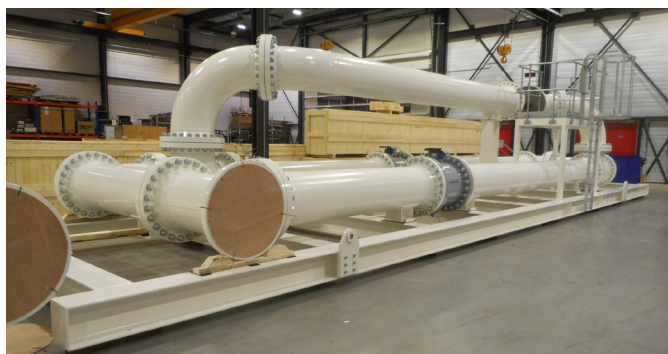
Изготовление водомерных узлов на заводе KROHNE в Бреде, Нидерланды
