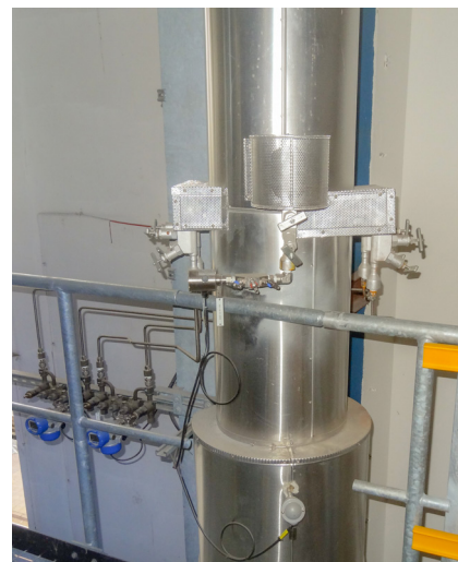
Kalibrovaná měřicí souprava s Venturiho dýzou, OPTIBAR DP 7060, OPTIBAR PM 3050 a OPTITEMP TRA-S34
