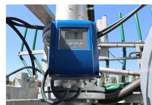
KROHNE Durchflussmessgerät auf dem Gülleausbringer installiert
