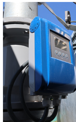
Durchflussmessung von Gülle mit dem OPTIFLUX 2100
