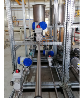
EMF ve Coriolis kütleli akışölçerleri ile dozajlama skidi
