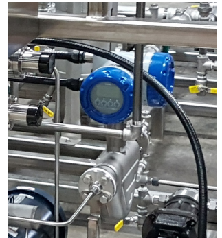
Durchflussmessung der ASA-Leimemulsion mit dem OPTIMASS 6400 C
