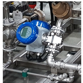
Durchflussmessung von Emulgator mit dem OPTIFLUX 4300 C
