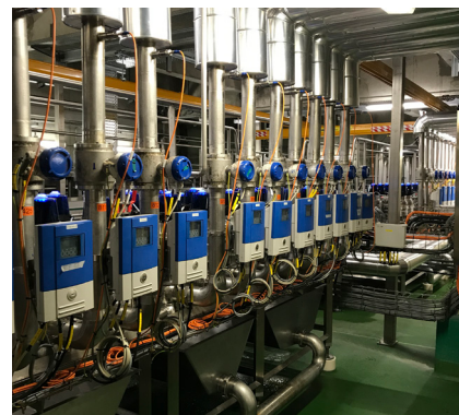
Měření průtoku piva průtokoměrem OPTIFLUX 6300 W (umístěn v blízkosti nádrže s pivem)
