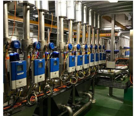
Durchflussmessung von Bier mit dem OPTIFLUX 6300 W (nahe Biertank installiert)
