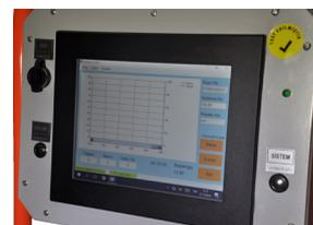
Aufzeichnungseinheit des Einpressmörtel-Überwachungssystems
