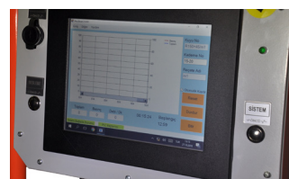
Záznamník zařízení pro sledování vstřikování malty
