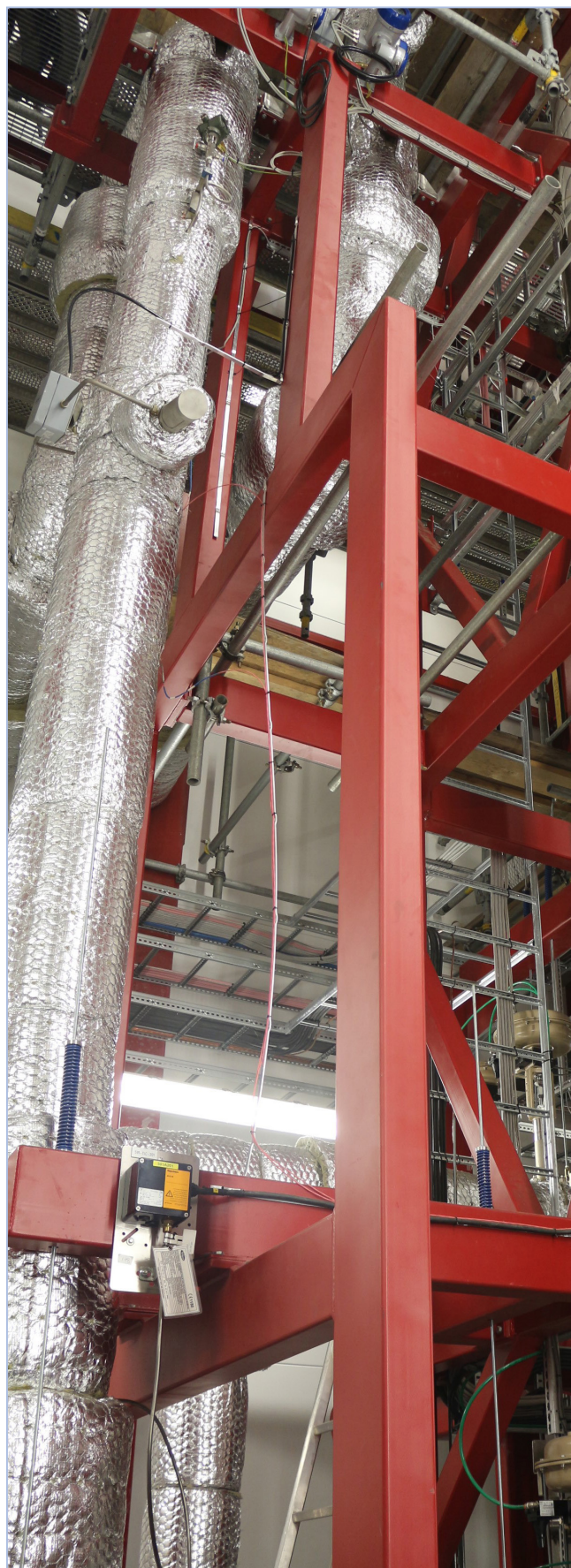
Ultrazvukové měření průtoku směsi vodíku a páry při vysokých teplotách
