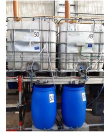
Durchflussmessung von Filtrat aus der Schlammbehandlung mittels Pflanzenbeeten
