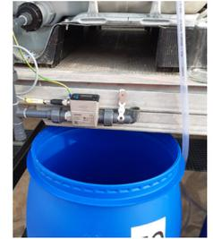
AF-E 400 in Kunststoffleitung montiert
