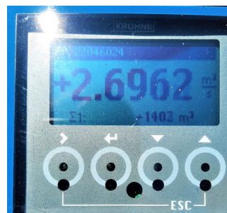
Messwertanzeige auf dem wandmontierten Messumformer
