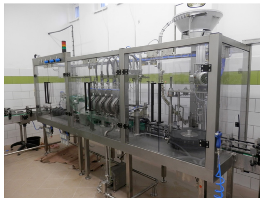
OPTIBATCH 4011 in paralleler Einbauweise auf der linearen Abfüllanlage installiert
