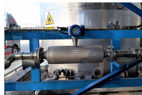
Durchflussmessung von Bioethanol mit dem OPTIMASS 1400
