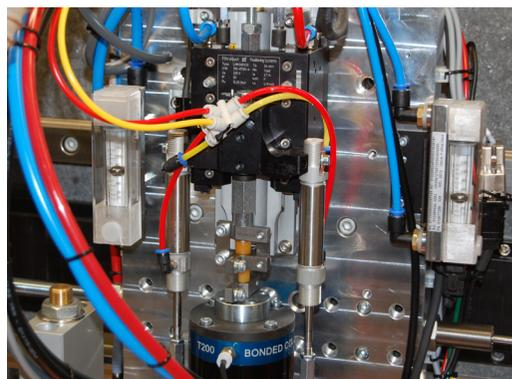
Mesure de débit à section variable de liquide de refroidissement
