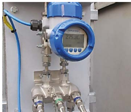
OPTIBAR DP 7060 in een chemische distillatiekolom
